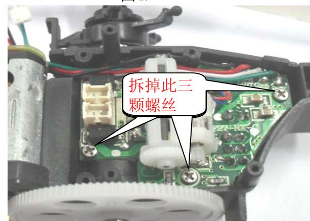
第三步. 按上图4示拆掉这四颗螺丝，向外即可取出“032”，如下图5示拆掉此四颗螺丝，再用烙铁焊掉红蓝线（如图6示），即可把左线路板与左舵机组件拆下来，拆右线路板与右舵机组件与拆左边一样。
