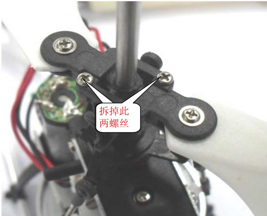
第二步. 按下图2示拆掉两颗螺丝;
